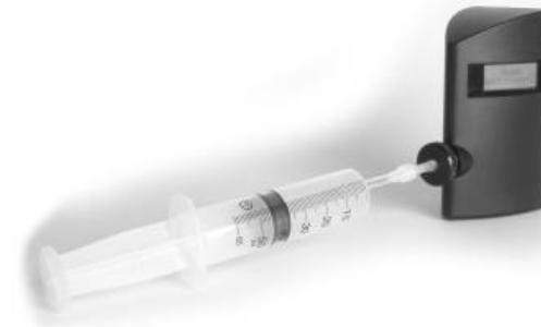
Cierre el flujo del gas, retire el sistema de toma de muestras de la pieza en T y desconecte el adaptador de calibración. Desenrosque la válvula de control fino y el indicador de flujo de la lata de gas y guárdelos en lugar seguro. Si se deja la válvula en la lata, el gas podría escapar.
