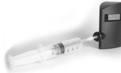
Interrompere quindi il flusso del gas, rimuovere il sistema di campionatura con raccordo a T e scollegare l'adattatore di calibrazione. Rimuovere la valvola di controllo e l'indicatore di flusso dalla bomboletta di gas. Conservare con cura tutti i componenti. Nel caso in cui la valvola non venga rimossa dalla bomboletta, potrebbero verificarsi fuoriuscite di gas.
