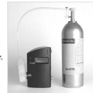
Ouvrez la soupape de contrôle de précision et laissez s'échapper un débit de gaz de 0,5 litres/minute. Pour maintenir ce débit régulier, ajustez l'écoulement de sorte que la bille située dans l'indicateur de débit reste au niveau de la ligne inférieure (voir diagramme ci-contre).
