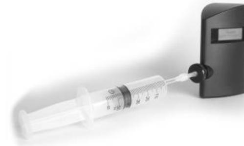
Draai de gastoovoer dicht, verwijder het T-stuk en haal de kalibratie-adapter los. Draai het controleventiel en de gasmeter van het gasflesje dicht en berg alles veilig op. Als het ventiel in het flesje blijft zitten, kan er gas ontsnappen.
