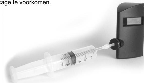
Verbind de injectiespuit met de bemonsteringsplug met een plastic slangetje (zie foto hier tegenover) Start de test op de normale manier en wanneer de display het volgende weergeeft:
