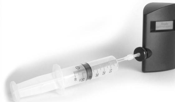
Collegare la siringa al tampone di campionatura utilizzando il tubicino in plastica (ved. l'immagine a fianco). Dare inizio al test nel modo consueto e quando il display visualizza:
