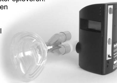
Kies de juiste kap uit en verbind deze met het daarvoor bestemde monsternamesysteem. Deze wordt dan verbonden met het T-stuk in plaats van een mondstuk. Zie de tegenoverliggende foto.
