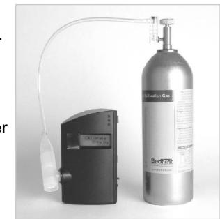
Open het controleventiel en laat het gas met 0,5 liter/minuut stromen. Doe dit door de gastoever zodanig te regelen dat de bal in de gasmeter op de onderste lijn blijft (zie het schema hier tegenover). Druk op de blauwe GO-knop en binnen drie seconden op de rode Nul-knop om het kalibratieproces te starten. De display geeft het volgende weer:
