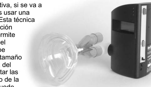
Para usar la máscara facial, seleccione la máscara adecuada y fíjela al sistema de muestreo de máscara facial. Luego, este sistema se conecta a la pieza en T en lugar de la boquilla. Vea la fotografía de al lado.
