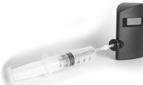
Conecte la jeringa al tapón de muestreo usando los tubos de plástico (véase la fotografía al lado). Comience la prueba de la forma normal y cuando la pantalla muestre:
