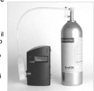
Aprire la valvola di controllo per consentire la fuoriuscita del gas ad una velocità di 0,5 litri al minuto. A questo scopo, regolare il flusso in modo tale che la pallina all'interno dell'indicatore di flusso rimanga in corrispondenza della riga inferiore (ved. schema a fianco).
