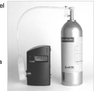
Abra la válvula de control fino y deje que el gas fluya a 0,5 litros/minuto. Para mantener este flujo, ajústelo de manera que la bola del Indicador de Flujo permanezca en la línea inferior (véase el diagrama de al lado).
