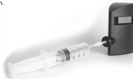
Schließen Sie die Spritze mit Hilfe des Kunststoffschlauchs an den Probenentnahmeverchluss an (siehe Foto gegenüber). Jetzt den Test wie gewöhnlich beginnen und sobald Folgendes angezeigt wird,:;
